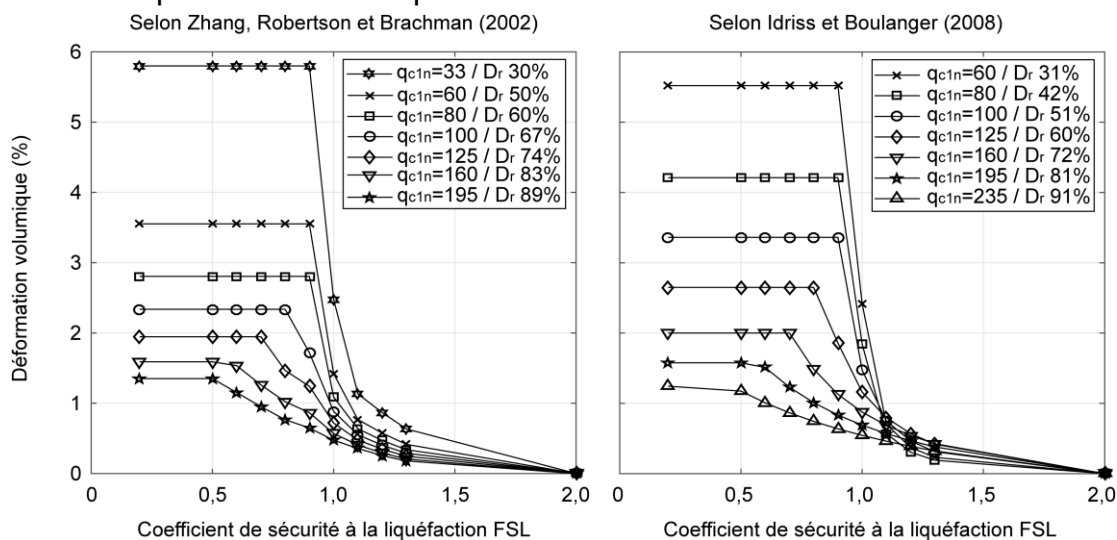
Figure 6. Présentation homogène des déformations volumiques (en %) évaluées par la méthode de Zhang et al. (2002) et par celle d'Idriss & Boulanger (2008) (utilisant l'équation 6).
