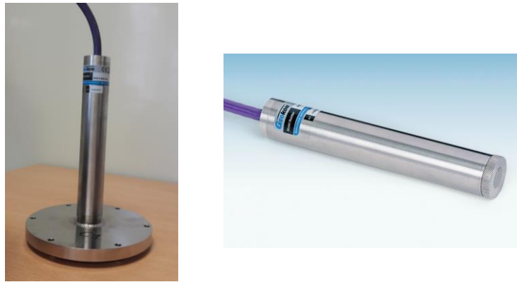
Figure 3 : Cellule de pression totale à gauche et cellule de pression interstitielle à droite
