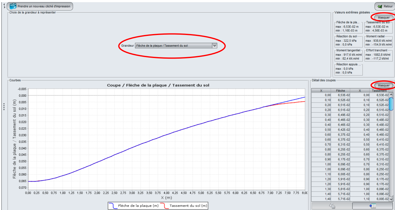
Figure I.79 : Coupe graphique : exemple de projet 2D axisymétrique - Flèche de la plaque/tassement du sol
