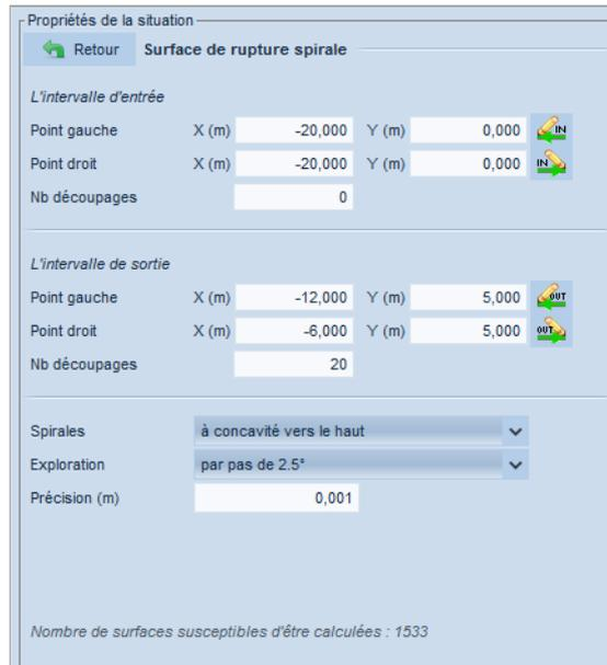
Figure 110. Paramètres de recherche des spirales logarithmiques pour la situation 1 de la phase 2
