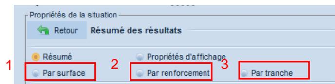
1. **Par surface** : tableau des résultats détaillés par surface de rupture (cf. Figure 30). La ligne surlignée en rouge correspond à la surface de rupture critique. Lors d'un clic sur une ligne du tableau, le cercle correspondant apparaît sur le dessin.
