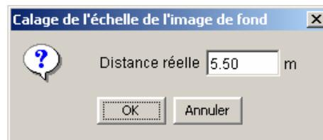
Figure 20 : calage de l'échelle de l'image du fond de plan
