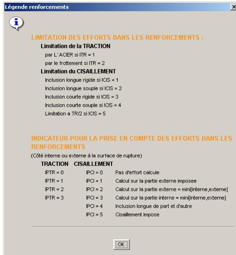
Figure 128 : légende pour les résultats dans les renforcements
