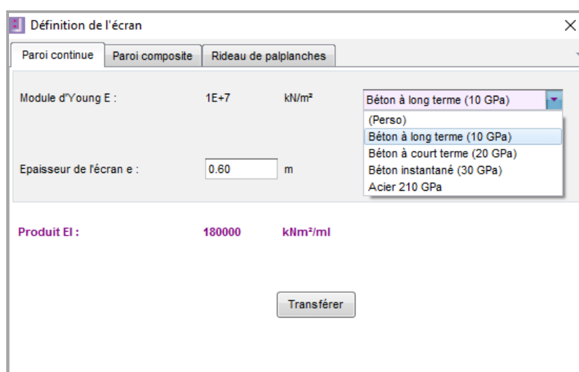
Figure B 32 : Détermination du produit EI pour les parois planes continues
