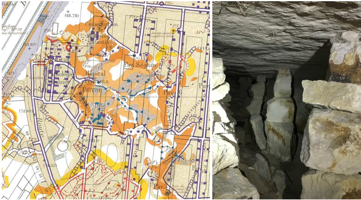
Figure 3. Exemple de carte IGC avec 3 niveaux de carrière au Kremlin Bicêtre ; photo de galerie dans cette même zone.
